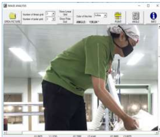
Gambar 1. Penentuan sudut postur kerja pada aktivitas mengambil bahan baku Sumber: Pengolahan Data, 2019
